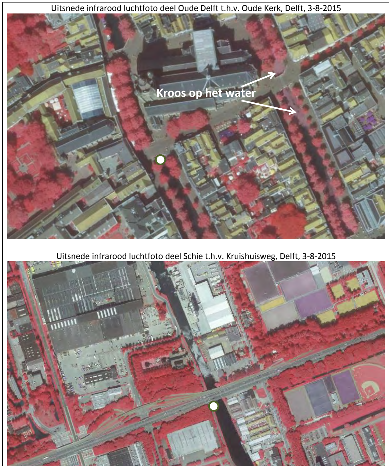
Figuur 14: Uitsnedes infrarood luchtfoto boven monsterpunten (wit met groene stippen) bij de Oude Delft, Delft en de Schie t.h.v. Kruithuisweg, Delft; op de bovenste foto wordt met pijlen aangegeven hoe kroos op dergelijke foto's er uit ziet
