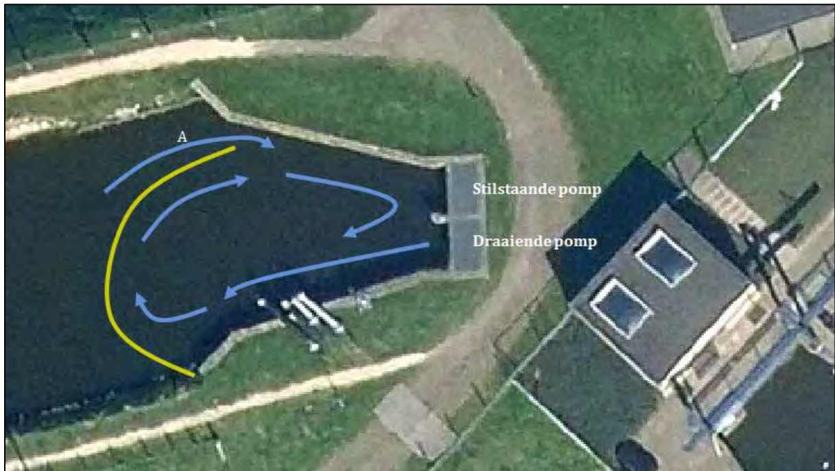
Figuur 16: situatie van de ontstane kolk bij inzet van 1 pomp; het krooscherm is de gele lijn, in blauwe pijlen de ontstane stroming voor wat betreft het wateroppervlak, en bij A werd door de stroming kroos langs het scherm geforceerd
