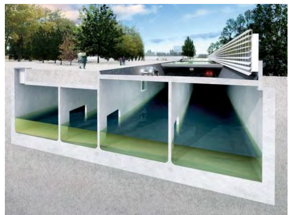
Figuur 54: Waterberging in parkeergarage (Gemeente Rotterdam, 2013).
