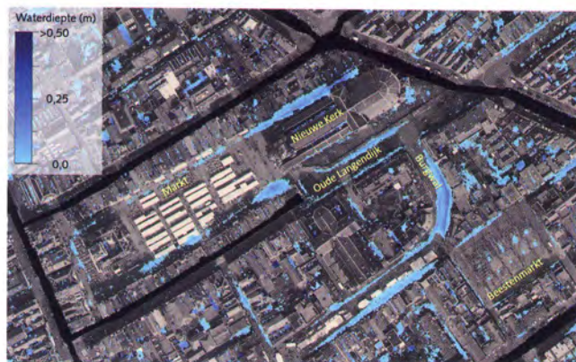
Figuur 2: Wateroverlast bij een slecht functionerende riolering, na een hevige bui.
